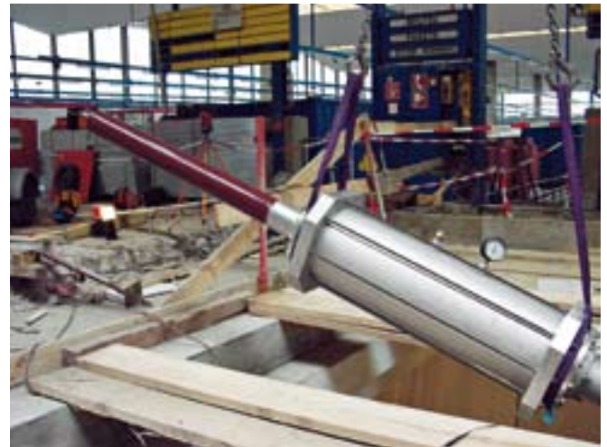
Bild 11: Prüfmuffe mit steckbarem Prüfadapter.
