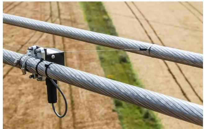
PT1-Sensor für Teilfeldschwingungsmessung
