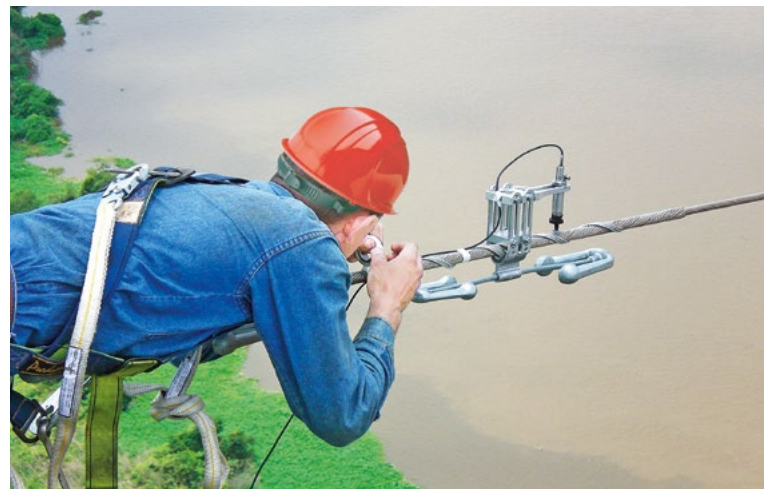
Mesure des oscillations de portée
