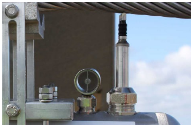
Capteur LVDT et anémomètre
