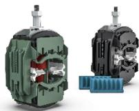
Bei der Produktfamilie ISICOMPACT handelt es sich um eine Abzweigklemme für den Niederspannungsbereich mit patentierter Einzelschraubverbindung. Aufgrund der umfangreichen Sicherheitsmerkmale (Berührungsschutz, kein Abisolieren erforderlich) der ISICOMPACT kann die Installation ohne Abschaltung der Stromversorgung erfolgen. Auch diese Abzweigklemme ist mit dem patentierten Schraubanschluss ausgestattet, der eine einfache und fehlerfreie Installation gewährleistet.
